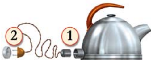
Мал. 38. Порядок вмикання електроприладу
